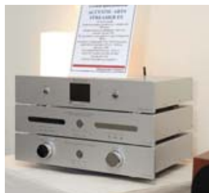
Сетевой плеер Streamer ES от Acoustic Arts (на фото сверху) вышел в январе нынешнего года. Он принимает потоковое аудио по Wi-Fi и Ethernet, обложки дисков выводятся на ЖК-монитор. Аппарат может работать в режиме «чистого» ЦАП, в котором отключаются все сетевые платы. Цена — 176 тыс. руб. (T-Art)
